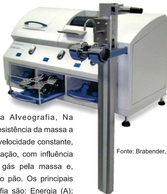
Extensografo: análise similar a Alveografia, Na extensografia é medida e registrada a resistência da massa a extensão, enquanto ela é esticada em velocidade constante, após períodos de descanso e fermentação, com influência sobre a expansão e a retenção de gás pela massa e, conseqüentemente, sobre o volume do pão. Os principais parâmetros avaliados pela extensografia são: Energia (A); Resistência a Extensão (R); Resistência Máxima (RM); Extensibilidade; Número Proporcional (R/E).
