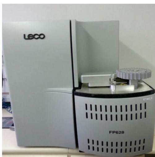
Analizador de Nitrogênio: Equipamento utilizado para a análise de proteína. Equipamento de última geração adquirido para substituir o elementar que foi transferido para o moinho de trigo.
