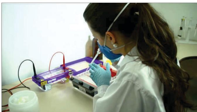
Aplicação de amostras em gel de agarose para realização da técnica de identificação de espécies de *Helicoverpa spp.* através de PCR – Reação de Polimerase em Cadeia
