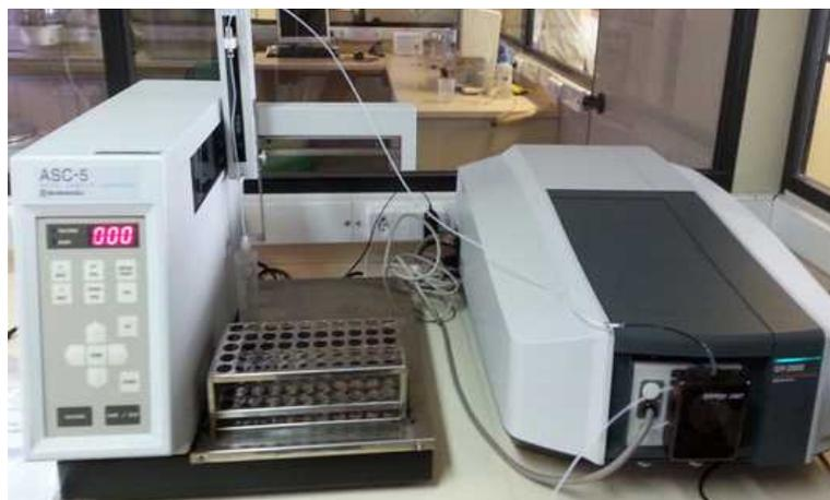
Espectrofotômetro UV/VIS: Mais novo equipamento do laboratório totalmente automatizado adquirido para o projeto ambiental, mas também que atende à demanda de solos e bromatologia. Utilizado para determinação de fósforo, boro, enxofre, nitritos, nitratos, dentre outros.
