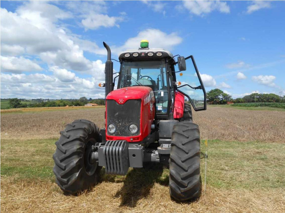
Figura 2. Trator equipado com piloto automático utilizado para causar compactação.
