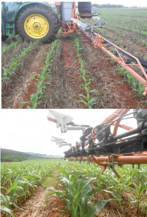
Figura 2. Equipamento WeedIt instalado no pulverizador, aplicando inseticida em milho.
