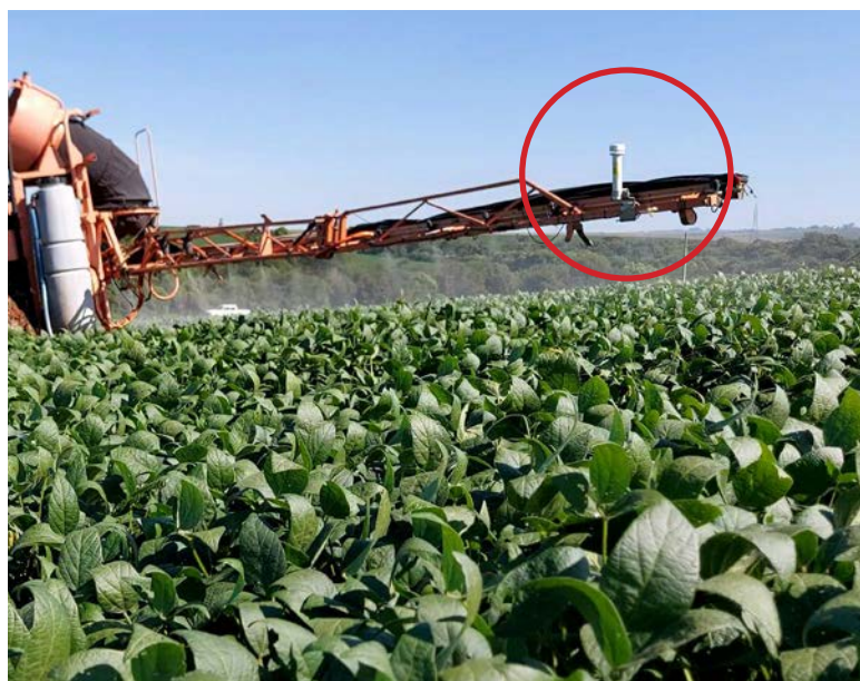
Sensor instalado junto a barra, que foi registrando dados do ambiente, como temperatura, umidade do ar e direção do vento, durante o serviço, permitiu o acompanhamento da pulverização
