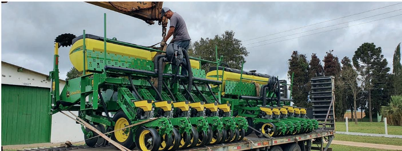
As semeadoras da marca John Deere, estão configuradas com seis linhas de 45 centímetros e com sistema pneumático de plantio, igual ao modelo já adquirido no ano passado, que está atendendo o CDE Itaberá (SP).
