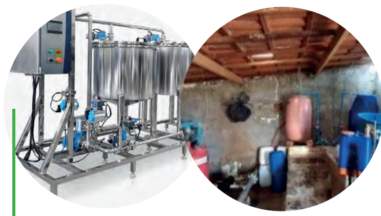
Exemplos de estruturas e equipamentos em que a reprodução de agentes biológicos no sistema on farm vem sendo feita no país.
